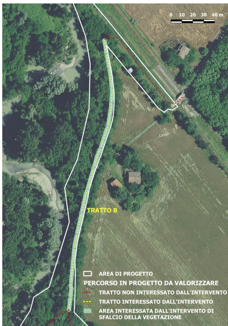
Figura 16 - Interventi sul tratto B : taglio della vegetazione infestante e riprofilatura del piano calpestabile con aggiunta di stabilizzato.
