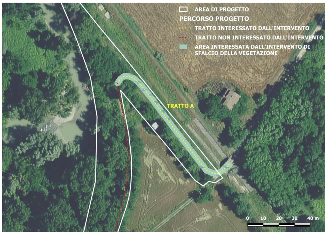
Figura 14 - Interventi sul tratto A : taglio della vegetazione infestante.
