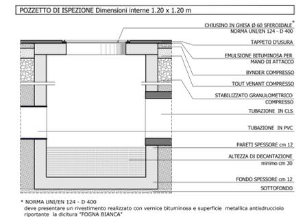
\* NORMA UNI/EN 124 - D 400 deve presentare un rivestimento realizzato con vernice bituminosa e superficie metallica antiscivolo riportante la dicitura "FOGNA BIANCA"
