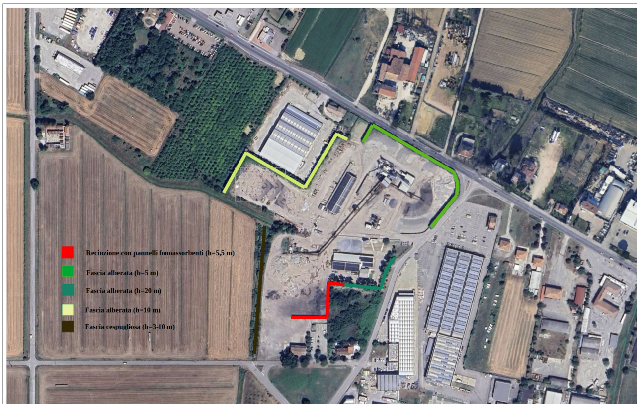
Figura 10: Ortofoto dello stabilimento con evidenziate le mitigazioni “fisiche”
