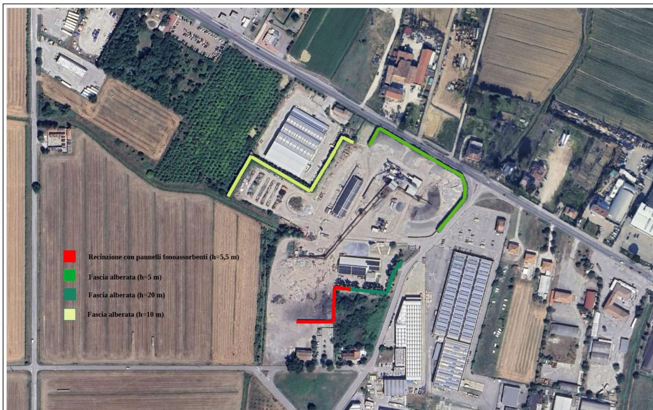
Figura 9: Ortofoto dello stabilimento con evidenziate le mitigazioni “fisiche”
