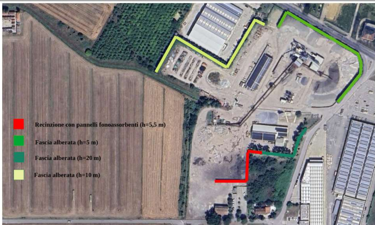
Figura 63: Barriere fisiche di stabilimento per rumore e polvere secondo DET-AMB-2016-356
