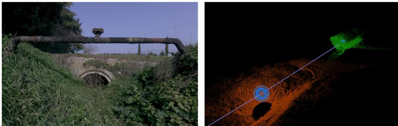
a sinistra: Fotografia del canale – a destra: Elaborazione fotogrammetrica con laser scanner
