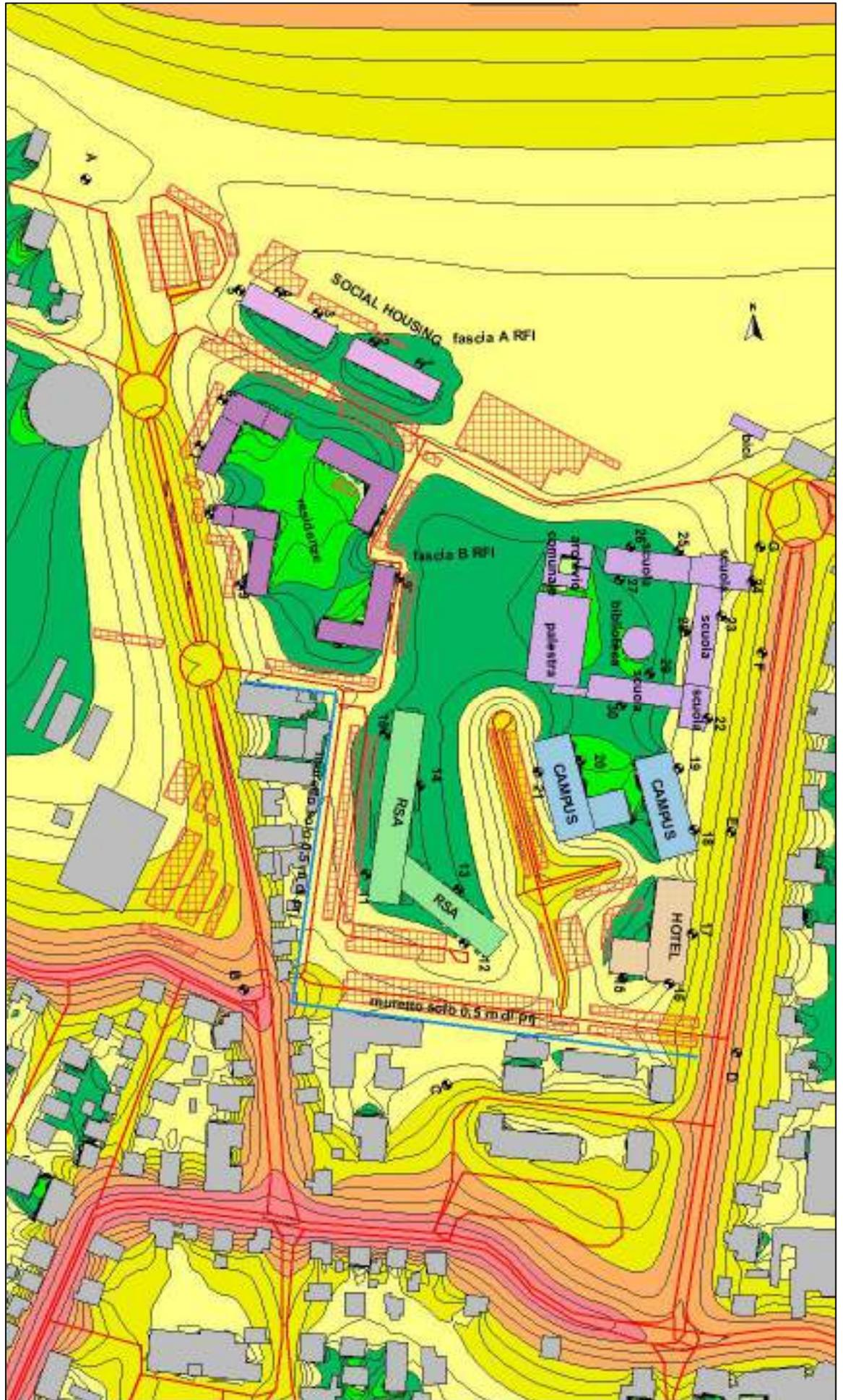
Immagine 15 - Mappature isolinee allo stato di progetto, giorno e notte, orizzontali a 1,7 m, a 4 m ed a 7,7 m da terra
