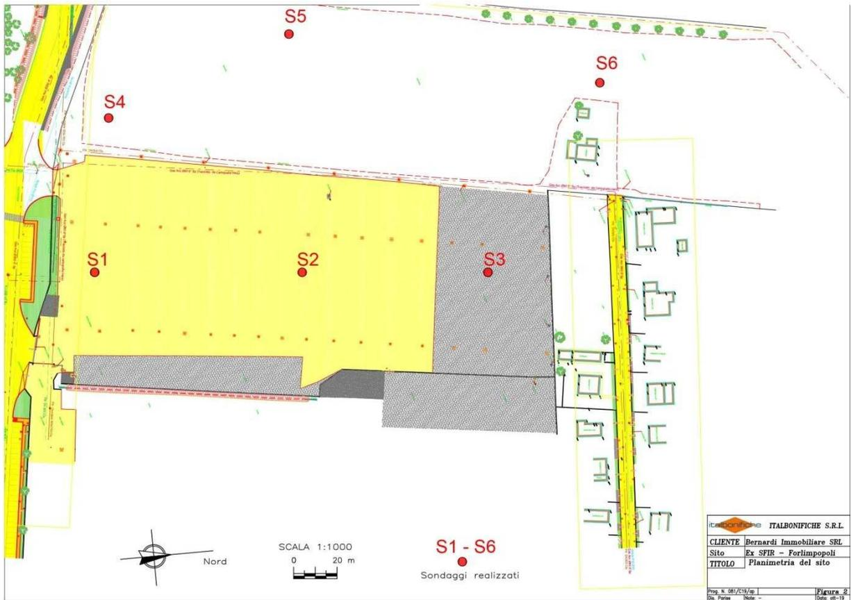
(planimetria con punti di sondaggi condotti da Italbionifiche)
